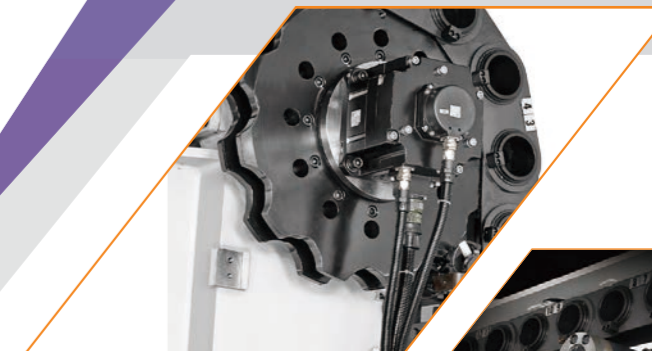
• 伺服電機與低背隙減速機結合成之傳動機構。
