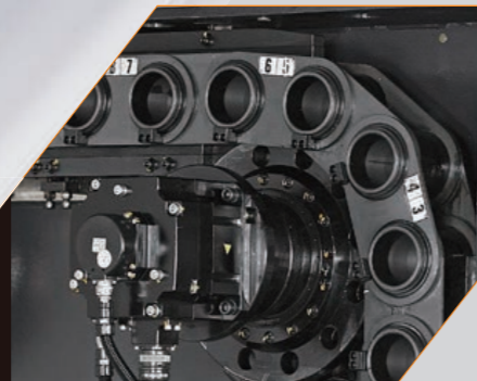
• 伺服電機與低背隙減速機結合成之傳動機構。
